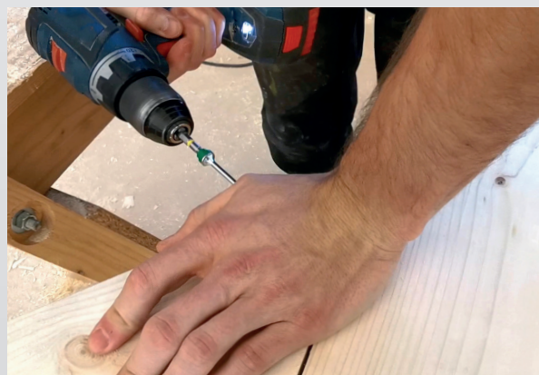
Makkelijk schroeven op plaatsen waar het niet mogelijk is de schroeven met de hand vast te houden
